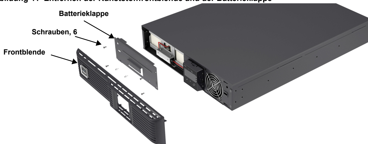
Abbildung 41 Entfernen der Kunststofffrontblende und der Batterieklappe
