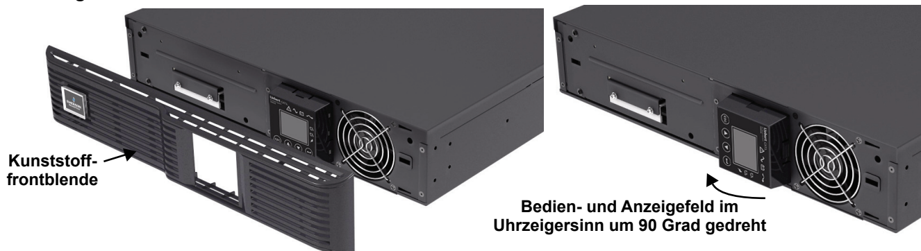
Abbildung 8 Entfernen der Kunststofffrontblende
